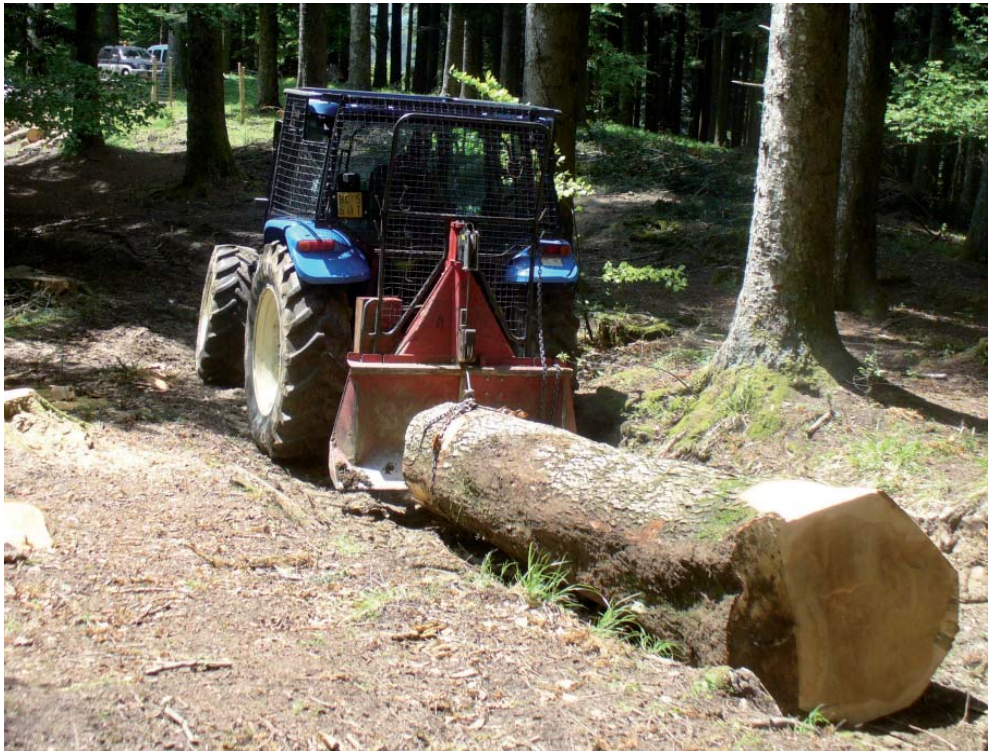
10. Esbosco a strascico con trattore e verricello (conifere)
