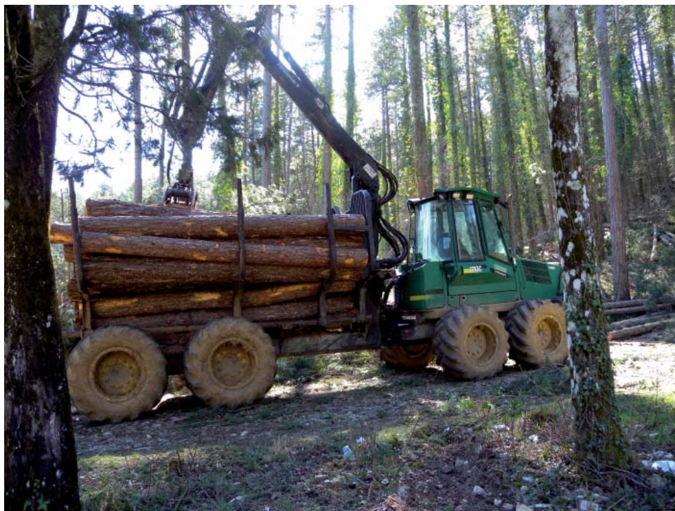
11. Esbosco con trattore portante ( forwarder )
