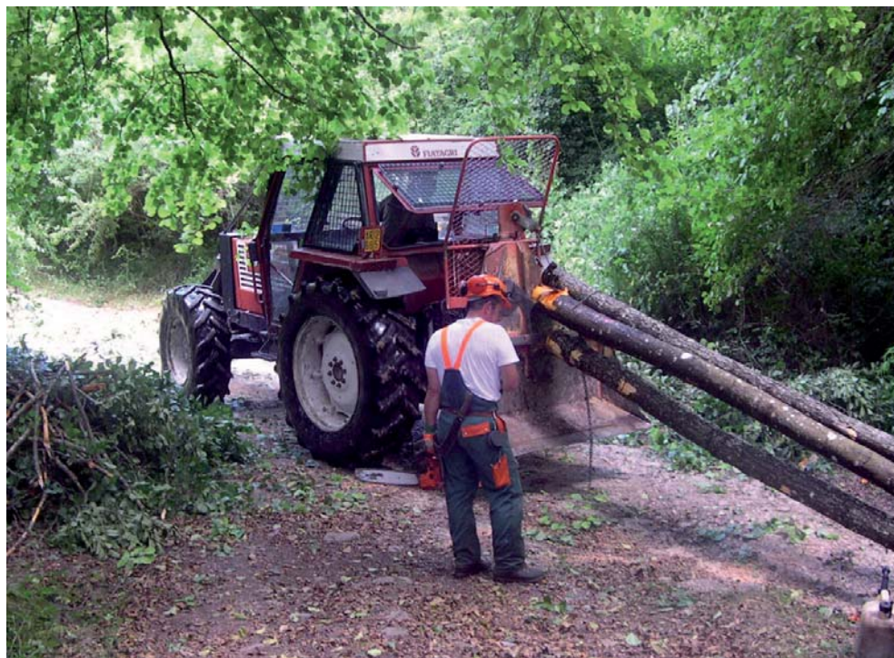
8. Esbosco a strascico con trattore e verricello (latifoglie)
