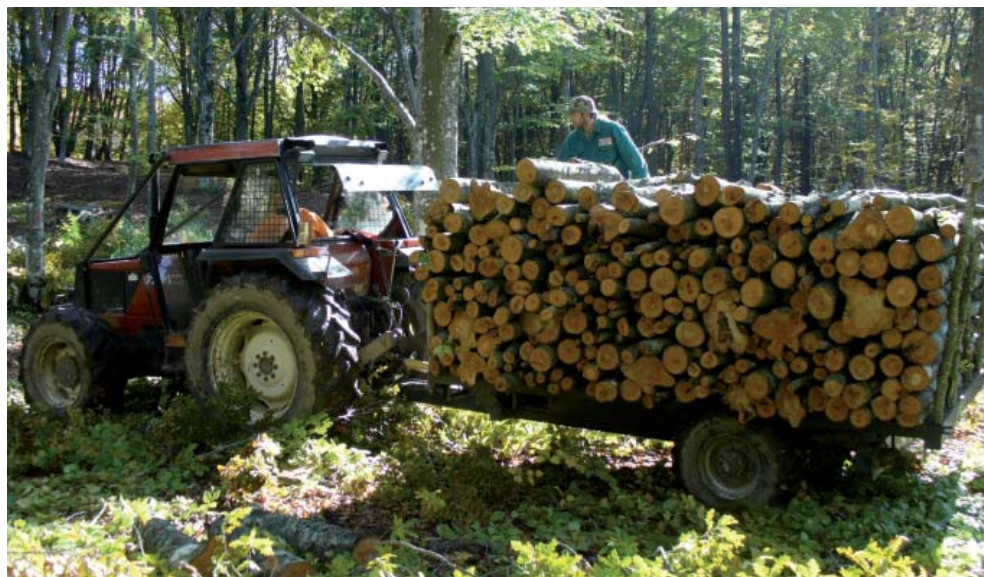
3. Esbosco con trattore agricolo d.t. e rimorchio r.m.
