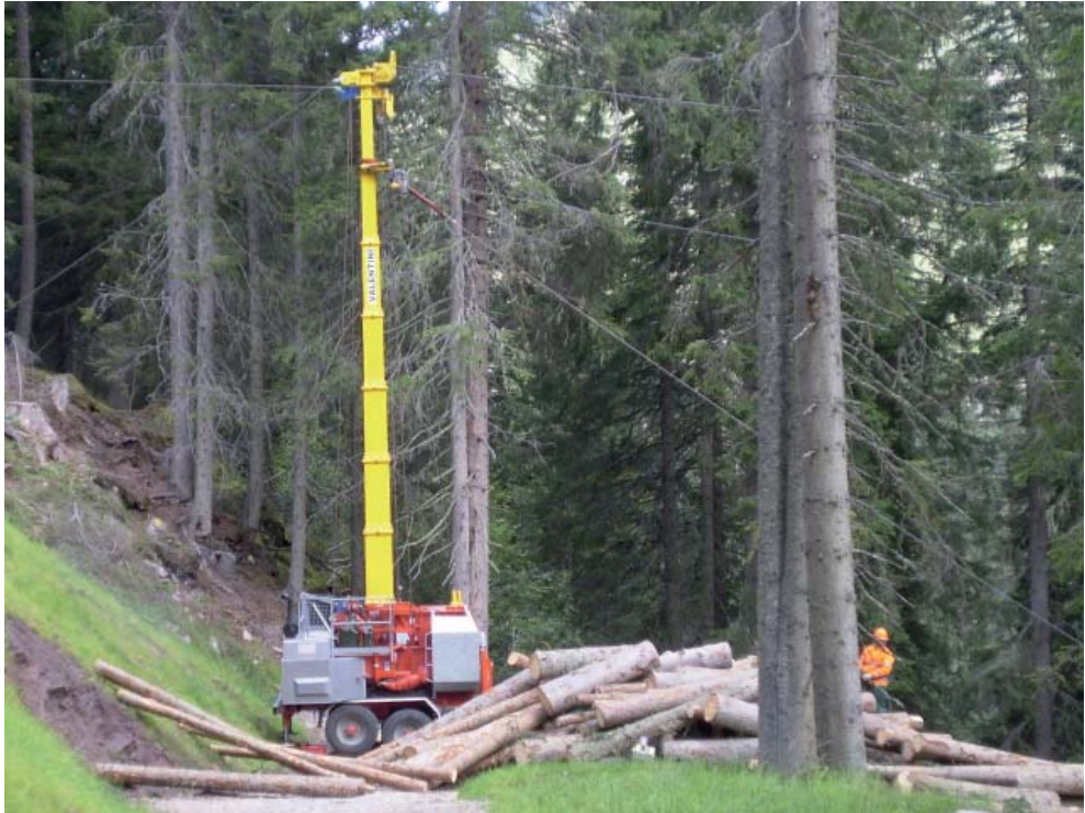
12. Esbosco con teleferica tipo gru a cavo
