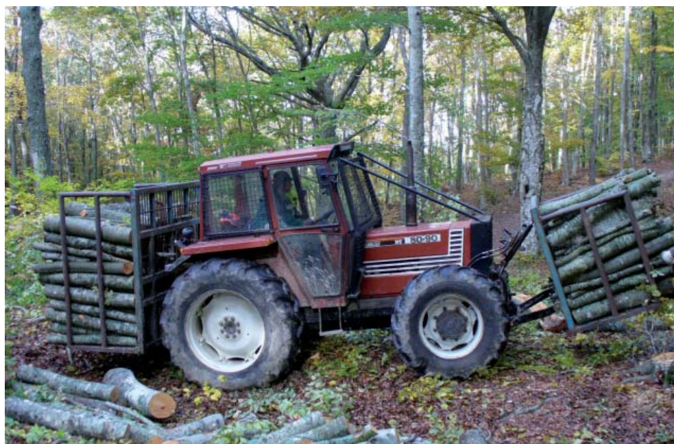
5. Esbosco con trattore agricolo d.t. con gabbie
